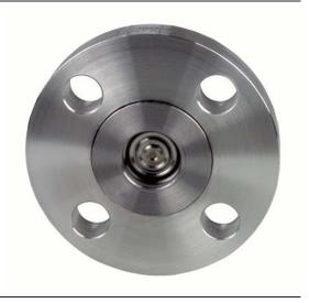
Realizados para isolarem os elementos sensíveis dos manômetros, pressostatos, transmissores de pressão, fluidos de processo corrosivos, viscosos, sedimentados e com altas temperaturas e pressões. Uma membrana sobreposta a teste de vedação garante a separação do fluido de transmissor do processo. A posição da membrana permite uma profunda limpeza. A conexão flangeada norma ASME e UNI-DIN nos permitem a sua utilização em plantas, químicas e petroquímicas, tratamento de água e papel e celulose.
